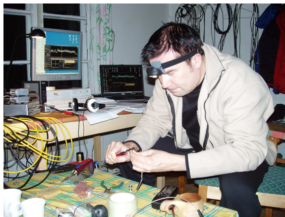
VJR asentaa BNC-liitintä koaksiaalikuluristimeen.
